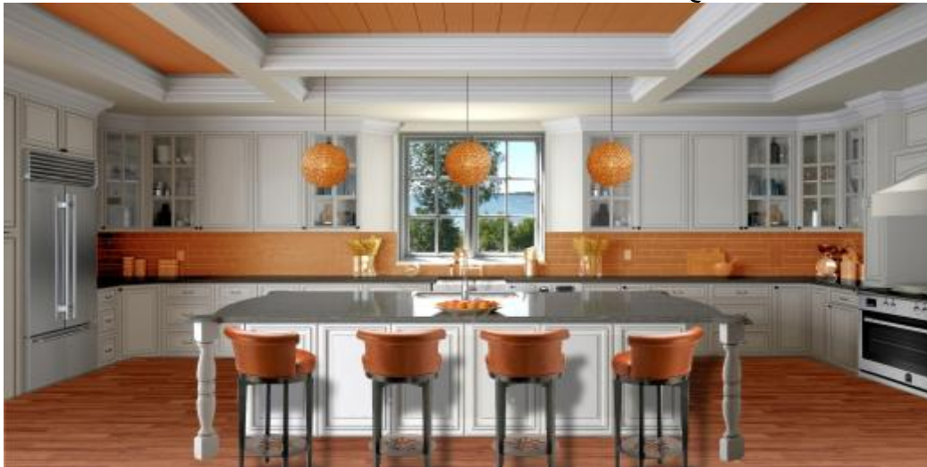
شكل رقم (19) منظور يوضح التصميم المقترح للمطبخ حيث يظهر به مناطق العمل والجزيرة ملحق بها مقاعد لتناول الطعام ومراعاة التهوية والإضاءة الطبيعية والصناعية، ومساحات التخزين المتنوعة ما بين ضلف خشبية وزجاجية وأدراج منزلقة.
